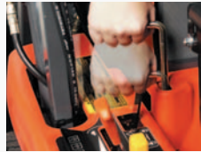
Reiniging van het achterste deel van het kanaal.
